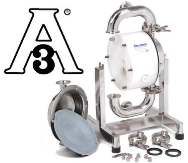
Bombas de doble diafragma, serie AODD y DME. Fabricadas en acero inoxidable electropulido 316L. (Tanto en el interior como en el exterior) Diafragmas en teflón integrales y conexión Tri-Clamp. Bombas diseñada para el sistema CIP para su limpieza y desinfección.
